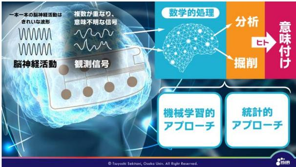
おでこから脳波を正確に測ります。それをビッグデータとして統計的アプローチ、及び信号を様々に分離し、特徴量抽出をする機械学習を行う。この二つのアプローチにより、信号を分析、掘削、意味付け
